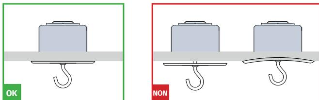
2 Orientez le crochet suivant l'illustration ou remplacez-le par la vis fournie s'il n'est pas au centre du couvercle.
