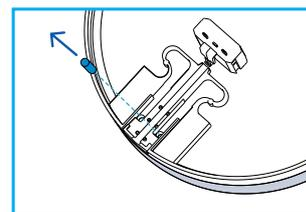
Clipser le luminaire en exerçant une pression au centre du diffuseur jusqu'à entendre « clic ».
